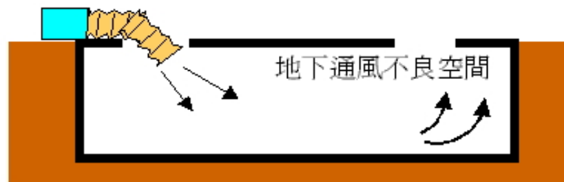
圖：有一個以上開口時應安排進氣出氣有適當流線減少死角
